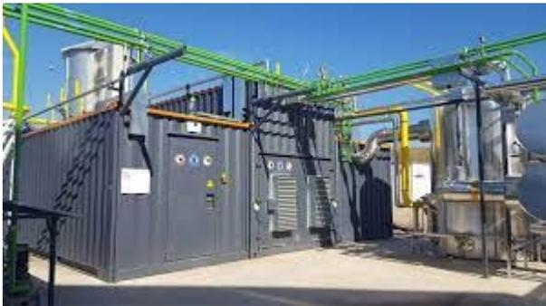
Il processo di raffinazione del biogas a biometano consiste in una purificazione suddivisa in diverse fasi e finalizzata principalmente alla rimozione dell'anidride carbonica fino ad ottenere un gas con concentrazione di CH<sub>4</sub> tra 97-98 %vol. Si riporta di seguito una schematizzazione delle fasi del processo di upgrading del biogas.
